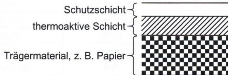
Abb. 1: Modelldarstellung des Aufbaus eines Thermopapiers 1
