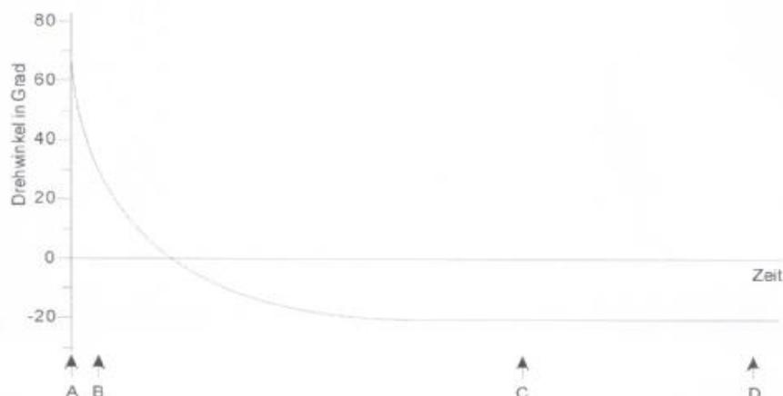
Abb. 1: Veränderung des Drehwinkels während der säurekatalysierten Hydrolyse einer Saccharoselösung
