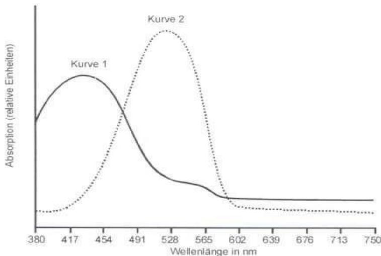
Abb. 4: Absorptionsspektren von Methylrot bei verschiedenen pH Werten<sup>1</sup>
