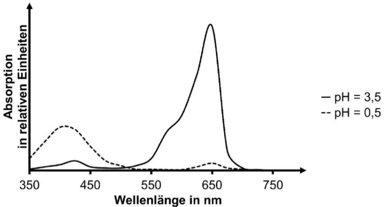
Abb. 5: Absorptionsspektren von E131 bei verschiedenen pH-Werten<sub>1</sub>
