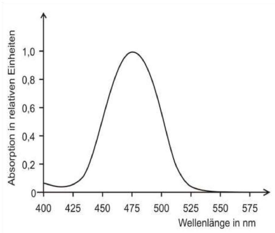
Abb. 4: Absorptionsspektrum eines Farbstoffes<sup>1</sup>
