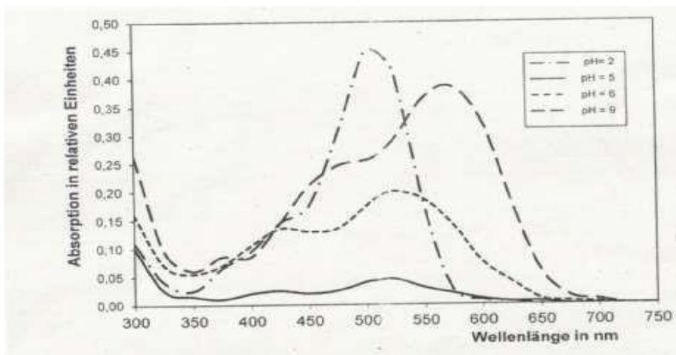
Abb. 4: Absorptionsspektren einer Cyanidin-3-O-β-glucosid-Lösung bei unterschiedlichen pH-Werten<sup>2</sup>
