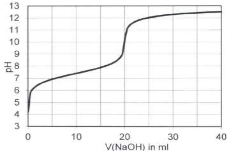
Abb. 2: Titrationskurve der Titration einer Vanillinlösung mit Natronlauge
