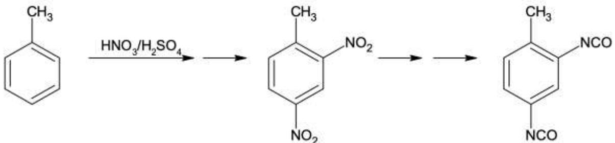
Abb. 5: Reaktionsschema zur Synthese von Toluol-2,4-diisocyanat
